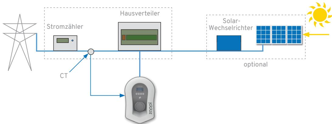
zappi mit PV-Überschußladen, dyn. Lastmanagement und kabelloser Steuerung (harvi)
