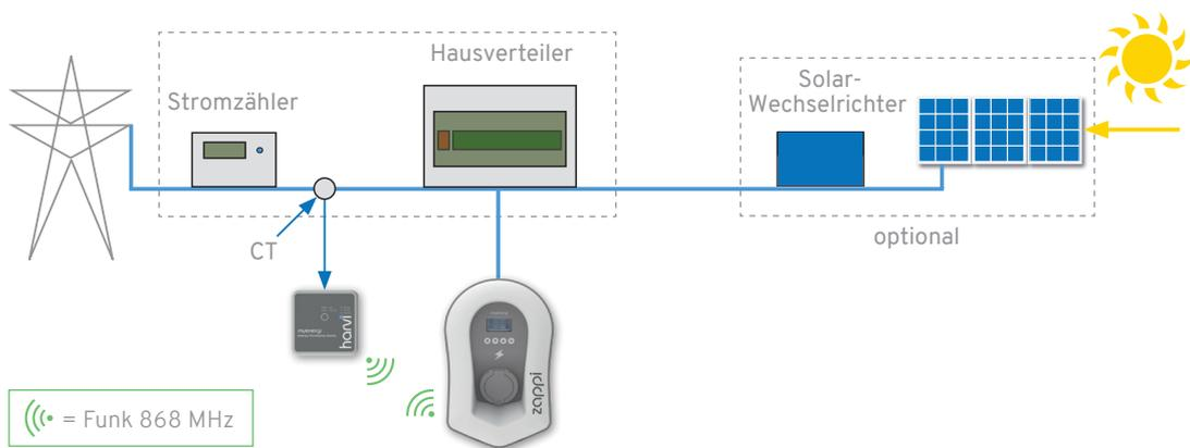
zappi mit PV-Überschußladen, dyn. Lastmanagement, kabelloser Steuerung (harvi) und App (hub)
