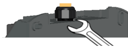
Fig. 6-15: Serrare il passacavo a vite dal retro
