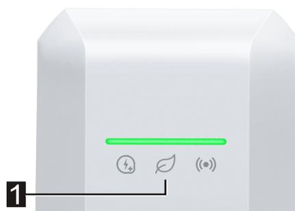
Le symbole Smart Charging (1) indique que le dispositif de contrôle du courant de charge intelligent réduit actuellement la puissance de recharge maximale. Cela peut entraîner un temps de recharge.
