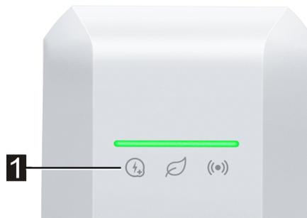
Si le courant de charge est limité par le dispositif de contrôle du courant de charge intelligent, l'icône Smart Charging s'allume. Dans ce cas, la limitation du courant de charge peut être annulée une fois pour la session de charge en cours à l'aide du bouton tactile (1) (surface tactile), si l'opérateur du réseau l'autorise. Le véhicule est ainsi rechargé plus rapidement en cas de besoin.
