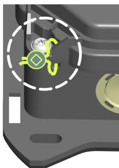
Le plombage du couvercle de protection permet de rendre visible tout accès non autorisé à l'intérieur de l'appareil. Cela permet notamment de sécuriser l'accès au raccordement de l'alimentation électrique, aux réglages électriques de base et aux modifications des composants.
