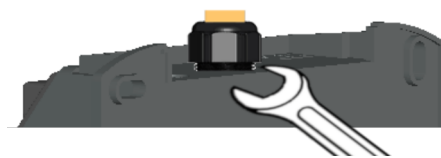
Fig. 6-15: Serrage du passe-câble à l'arrière
