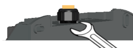
Fig. 6-15: Serrage du passe-câble à l'arrière
