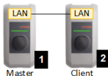
Abb. 2-3: Direkte Verbindung von Master und Client
