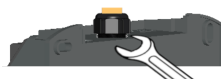
Abb. 6-15: Kabelverschraubung von der Rückseite festziehen
