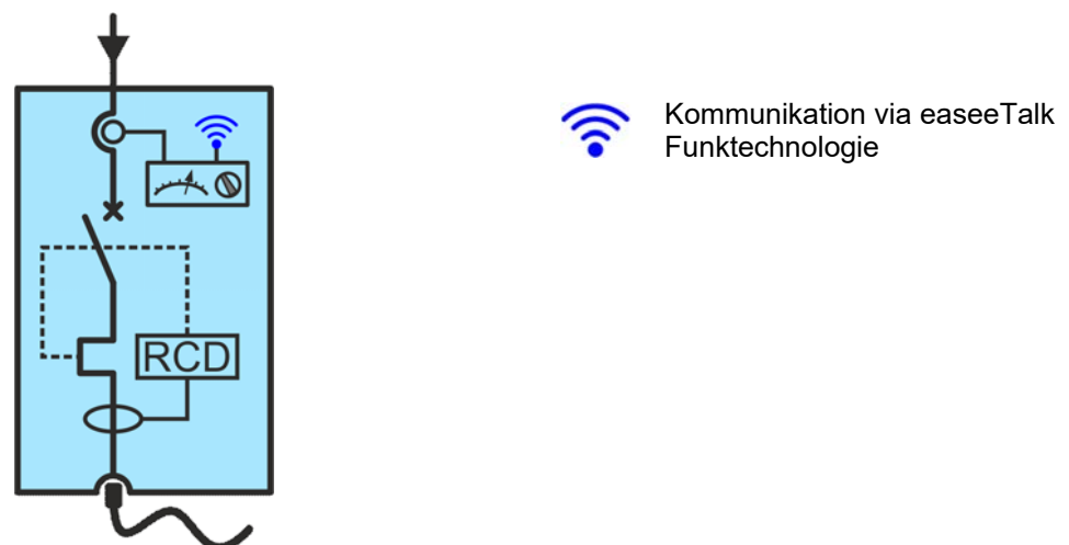
Bild 2 Prinzip Wallbox d) mit Überlast- und Fehlerstrom-Schutzeinrichtung
