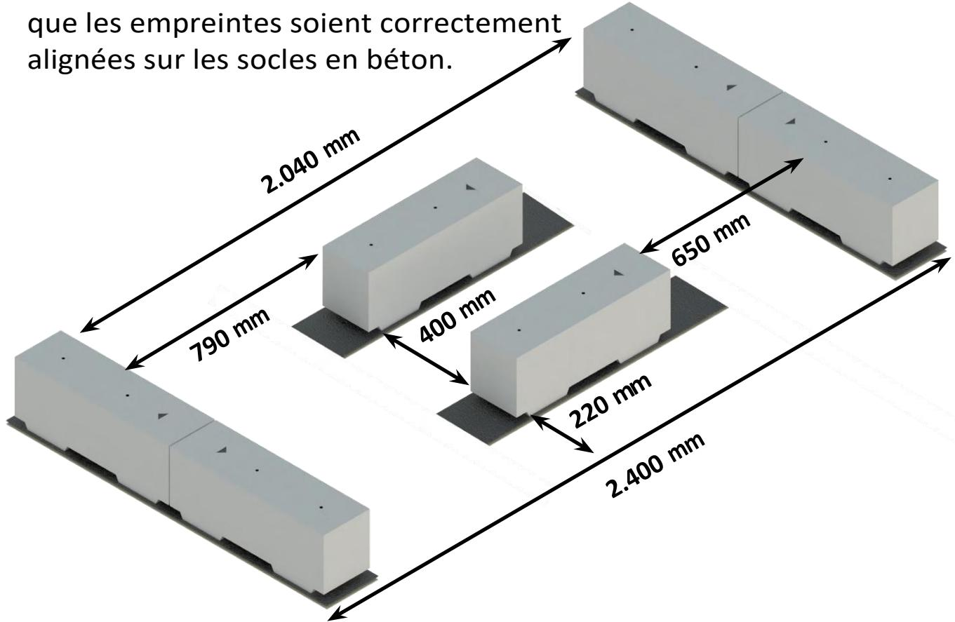
Lors de l'installation de plusieurs extensions, il est important de respecter la distance entre les socles en béton centraux.
