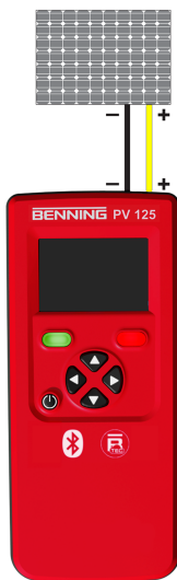
Illustration 5: Mesure de la tension en circuit ouvert et du courant de court-circuit
