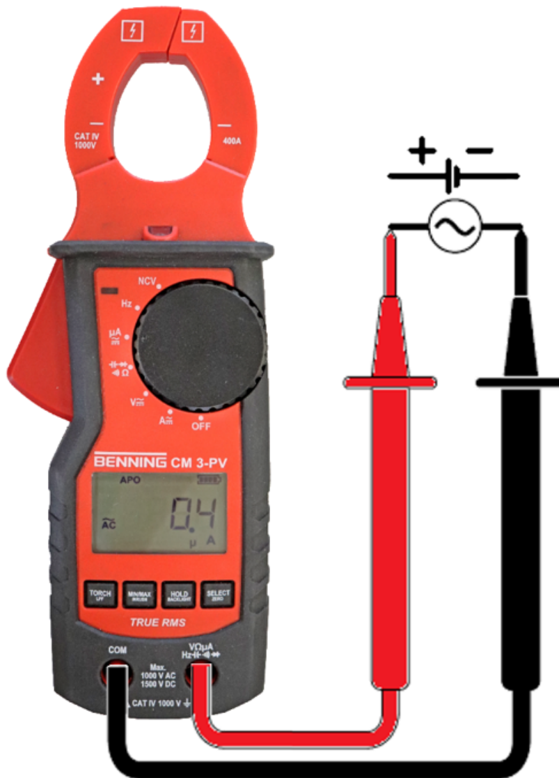
Illustration 11: Mesure de courant au moyen des câbles de mesure de sécurité ( \mu\text{A} )
