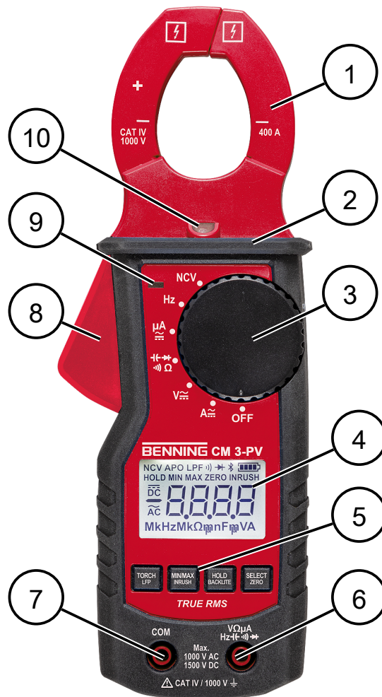
Illustration 6: Structure de l'appareil BENNING CM 3-PV
