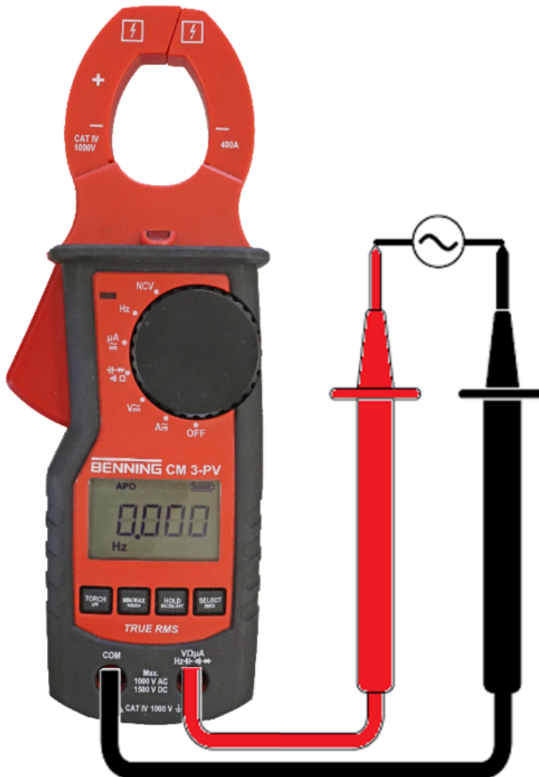
Illustration 12: Mesure de fréquence
