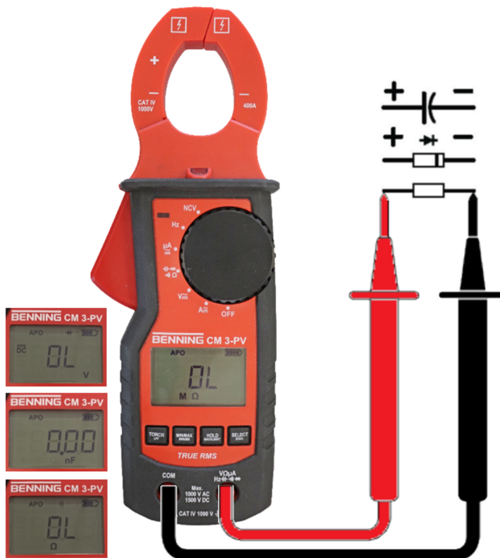
Illustration 13: Mesure de résistance, mesure de capacité, test de continuité ou contrôle de diodes
