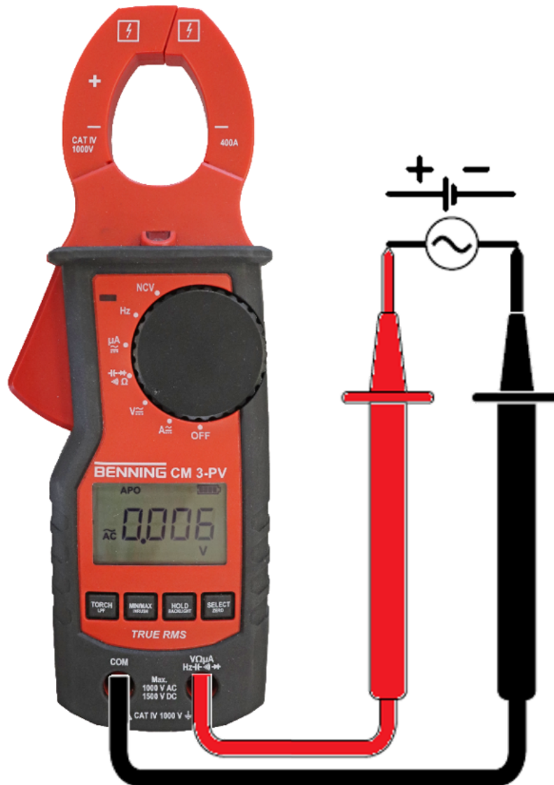
Illustration 9: Mesure de tensions continues et alternatives
