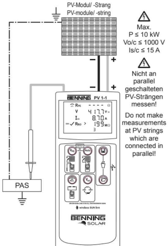
Bild 7: Spannungsmessung über 4 mm Prüfbuchsen
