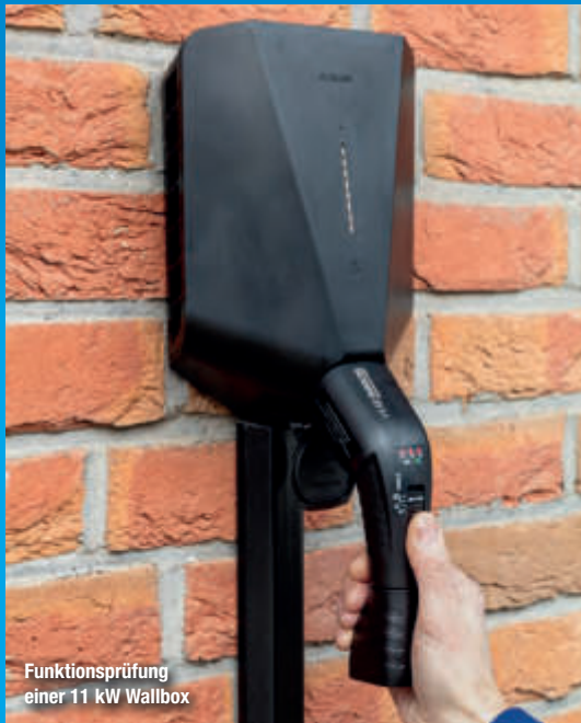
VDE-Sicherheitsprüfung mit Installationstester BENNING IT 200
