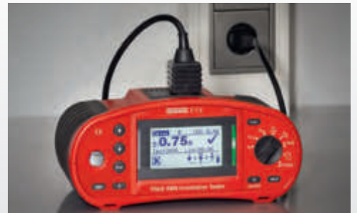
IT 115 bei der Schleifenimpedanzmessung ohne RCD-Auslösung
