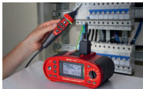
IT 130 mit der Commander-Prüfspitze bei der Prüfung einer elektrischen Anlage
