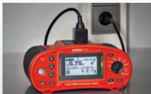
IT 115 bei der Schleifenimpedanzmessung ohne RCD-Auslösung
