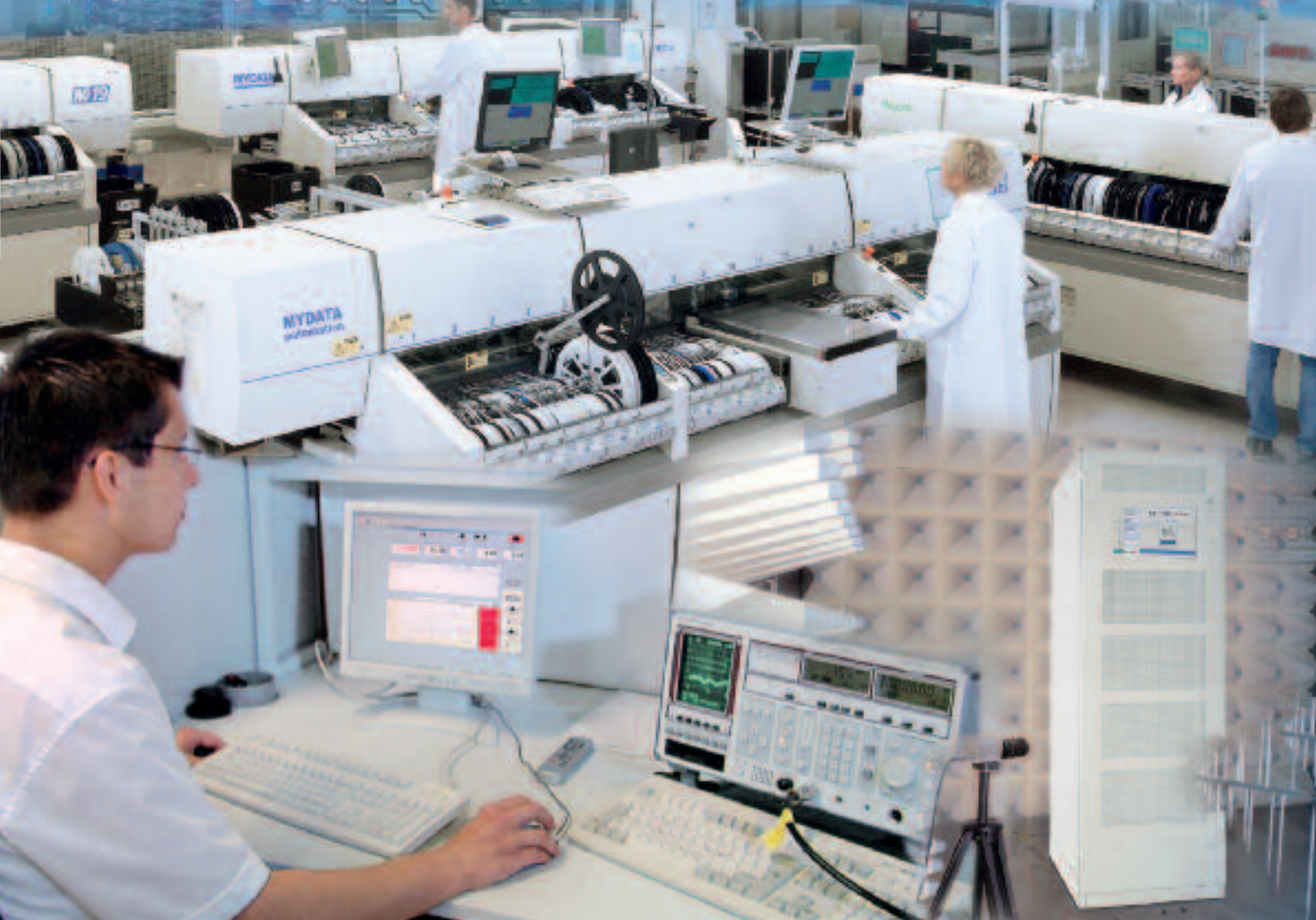
Die Leiterplattenbestückung erfolgt durch SMD-Bestückungsautomaten Printed circuit board insertion SMD technology
