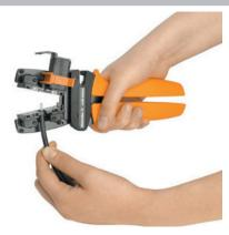
Kabel auf einer Länge von 7 ± 0,5 mm abisolieren.
