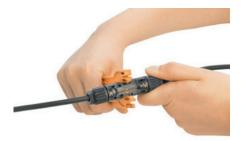
Mit Montagewerkzeug: Mit dem Montagewerkzeug die Rasthaken des Steckers zusammendrücken und die Gehäuseteile auseinanderziehen.
