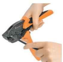
Den Metallkontakt in das Handwerkzeug legen. Kabelquerschnitt und Kavität entsprechend zuordnen. Der Locator hilft den Kontakt geeignet zu positionieren. Für das Crimpen die für den Leitungsquerschnitt vorgesehene Kammer nutzen.
