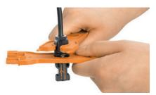
Die Kabeldurchführung mit dem Montagewerkzeug, wie im Bild gezeigt, anziehen. Das Anzugsdrehmoment muss in jedem Fall zum verwendeten Kabel passen. Die Klappe benötigt ein Drehmoment von 2,0 bis 2,5 Nm.
