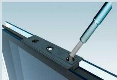
4. Die Modulanschlussdose nacheinander über die Befüllöffnungen mit der Scheibenversiegelung verfüllen
