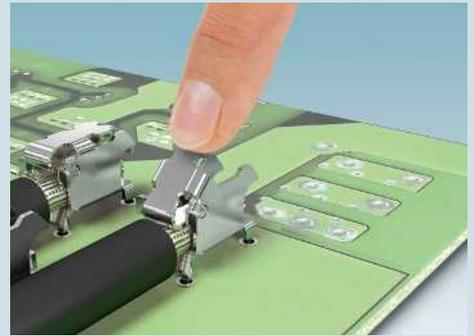
Abisolierten Leiter einführen, Feder einrasten – fertig
