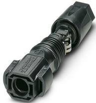
Connettore, Serie di prodotti: Sunclix, materiale custodia: PPE, colore: nero, numero poli: 1, sezione del conduttore min.: 2,5 mm<sup>2</sup>, sezione del conduttore max.: 6 mm<sup>2</sup>, tensione di dimensionamento: 1100 V DC, Corrente nominale: 35 A, Tipo di connessione: Molla, Tipo di connessione del contatto: Spina, diametro cavo min.: 5,5 mm, diametro cavo max.: 8 mm. Modello successivo al 1774687
