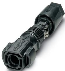
Photovoltaik-Steckverbinder, Artikelfamilie: Sunclix, Steckverbinder, Material Gehäuse: PPE, Farbe: schwarz, Polzahl: 1, Aderquerschnitt min.: 2,5 mm<sup>2</sup>, Aderquerschnitt max.: 6 mm<sup>2</sup>, Bemessungsspannung: 1100 V DC, Bemessungsstrom: 40 A, Anschlussart: Federkraft, Kontaktart: Stift, Kabeldurchmesser min.: 5,5 mm, Kabeldurchmesser max.: 8 mm
