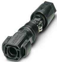
Steckverbinder, Artikelfamilie: Sunclix, Material Gehäuse: PPE, Farbe: schwarz, Polzahl: 1, Aderquerschnitt min.: 2,5 mm<sup>2</sup>, Aderquerschnitt max.: 6 mm<sup>2</sup>, Bemessungsspannung: 1100 V DC, Bemessungsstrom: 35 A, Anschlussart: Federkraft, Kontaktart: Stift, Kabeldurchmesser min.: 5,5 mm, Kabeldurchmesser max.: 8 mm. Nachfolgeartikel von 1774687
