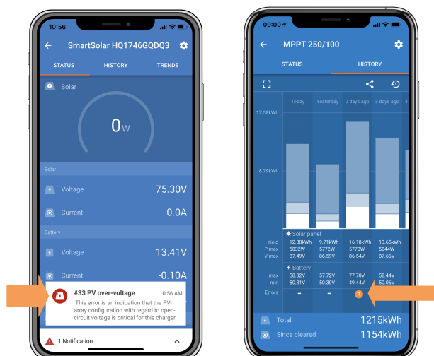
Un errore attivo e un errore cronologico.
