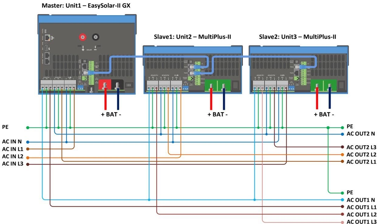
Des conditions supplémentaires sont requises pour les systèmes triphasés. Pour la documentation à ce sujet, voir [https://www.victronenergy.com/live/ve.bus:manual\\_parallel\\_and\\_three\\_phase\\_systems](https://www.victronenergy.com/live/ve.bus:manual_parallel_and_three_phase_systems)
