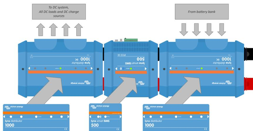
*Exemple de modules Lynx montés à l'envers : maintenant, les batteries se connectent sur le côté droit, tous les consommateurs et les chargeurs se connectent sur le côté gauche et les autocollants de montage à l'envers (inclus) sont apposés.*
