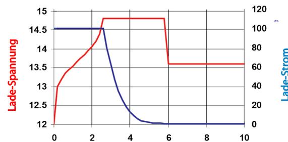
Bild 3: Dreistufen-Ladekennlinie
