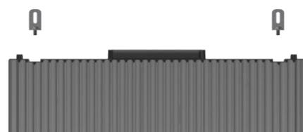
9. Richten Sie das Batteriemodul sorgfältig mit einer Wasserwaage aus.
