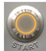
Sobald die 5 Sekunden verstrichen sind, blinkt der LED-Ring am Starttaster wie unten dargestellt. Der Energiespeicher wechselt in den Zustand Service (WLAN-Hotspot aktiviert).
