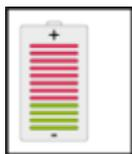
Neue Batteriemodule verfügen über einen Ladezustand von rund 30 %. Stellen Sie vor der Installation neuer Batteriemodule sicher, dass der Ladezustand des Bestandssystems ungefähr 30 % beträgt. Wenn dies nicht durchgeführt wurde, wird der Energiespeicher den Ladungsausgleich nach Installation des neuen Moduls automatisch durchführen. Durch große Ladungsunterschiede kann dieser Vorgang einige Wochen dauern. Währenddessen ist die Speicherkapazität eingeschränkt.
