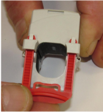
Einsetzen der Fixierspannen
