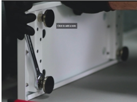
Abbildung 6: Bodenständer - Anziehen der Mutter
