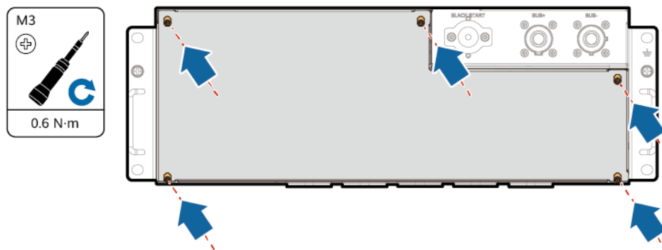
Figura 7-21 Installazione dello sportello del vano di manutenzione
