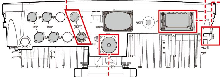
**EL** Εγκατάσταση Smart Dongle
