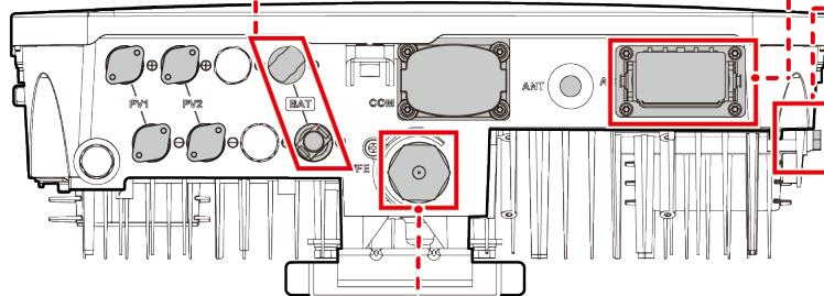
**NB** Koble til en PE-kabel
