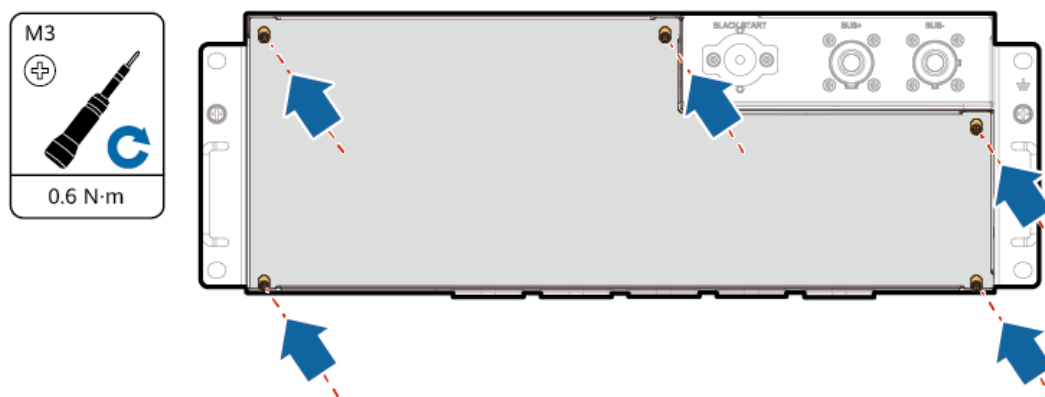
Abbildung 7-21 Einbau der Wartungsfachabdeckung
