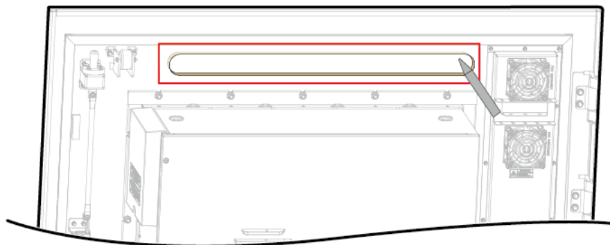
Abbildung 11-7 Gleichmäßiges Auftragen des Dichtmittels
