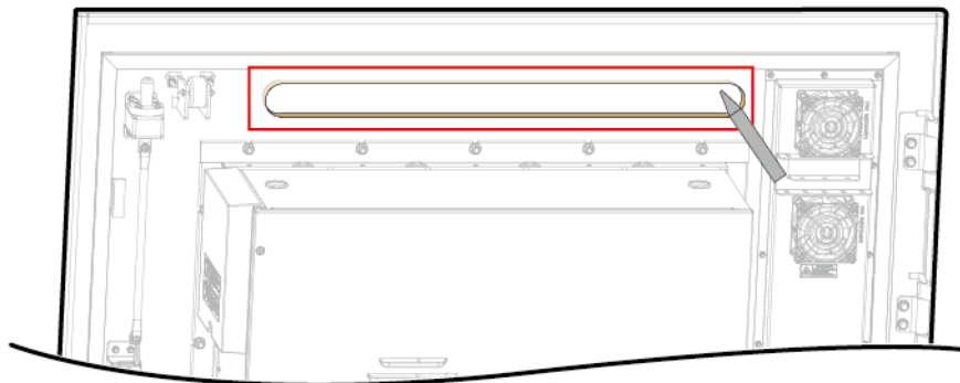
Abbildung 11-7 Gleichmäßiges Auftragen des Dichtmittels
