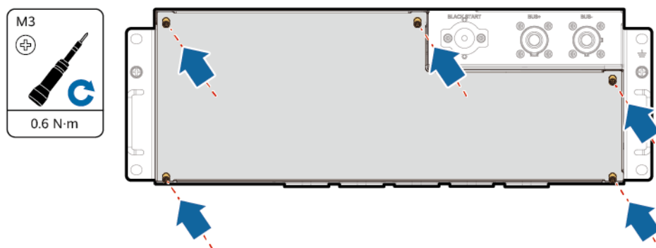
Abbildung 7-21 Einbau der Wartungsfachabdeckung
