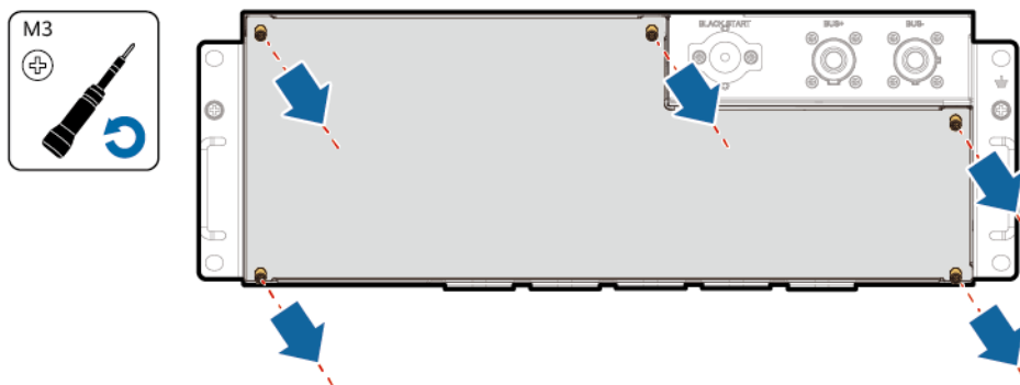
Abbildung 7-17 Entfernen der Wartungsfachabdeckung
