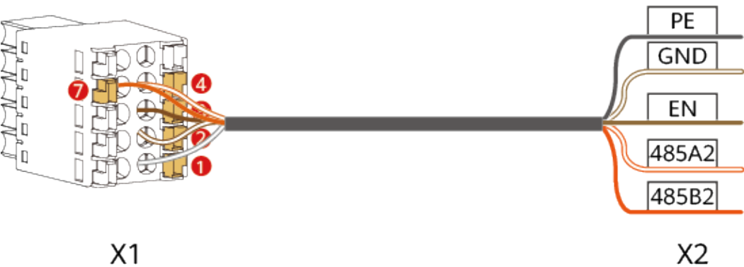
Abbildung 6-2 Signalkabel (vom Lieferanten gekauft, Typ 1) zwischen dem Akku und dem Wechselrichter
