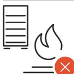
Ne pas installer la batterie à proximité de sources d'incendie ni de matériaux inflammables, explosifs et chimiques.
