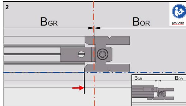
Aligner le profilé de gouttière sur la référence (bleu) et les pattes de fixation de profilé pour  $B_{OR}$ . Insérer le profilé de gouttière jusqu'à la butée de la patte de fixation de profilé.
