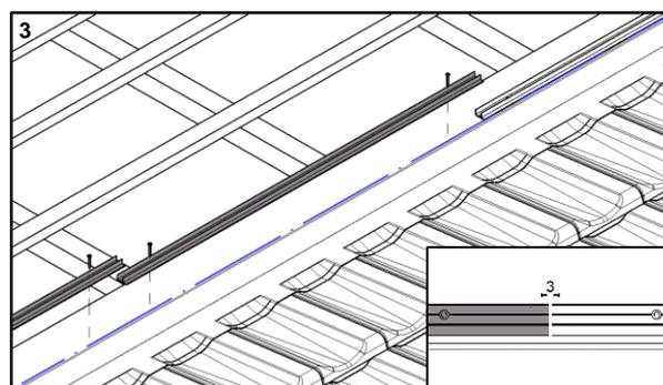
Poser d'autres profilés d'égout avec un écart de 3 mm.
