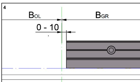
Raccourcir le dernier profilé de gouttière de 0 à 10 mm par rapport à  $B_{GR}$ . Si nécessaire, percer un trou de passage supplémentaire de  $\varnothing 6.4$  mm.
