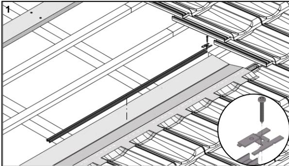
Positionner le profilé de gouttière et les pattes de fixation de profilé.
