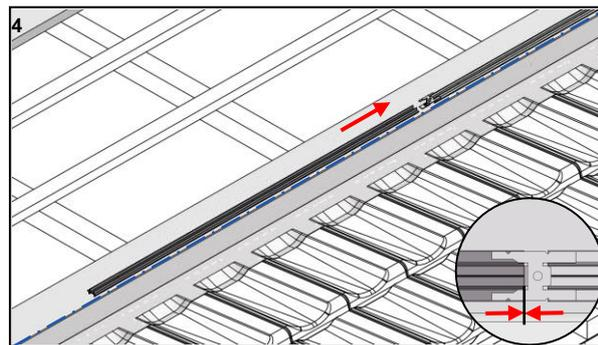
Pousser le profilé de gouttière suivant sous les pattes jusqu'à la butée et l'aligner sur la référence. Répéter l'étape jusqu'à l'extrémité du champ PV.
