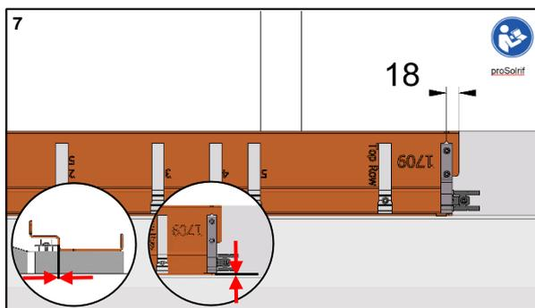
Fixer le gabarit de montage au profilé de gouttière. Placer l'étrier de montage avec le gabarit de montage.
