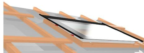
Ensuite, positionnez la fenêtre dans le cadre de la contre-lame en plaçant les angles fixés à la fenêtre sur les vis du cadre de la contre-lame.
