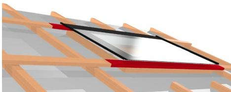
Complétez maintenant la sous-structure en bois encastrée jusqu'au cadre de contre-lattage, de sorte que le lattage du module soit à nouveau monté en continu sur le toit.
