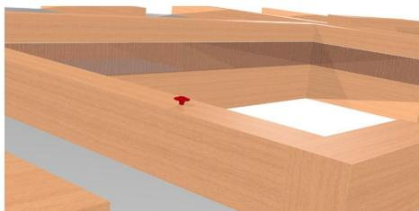
Vérifiez maintenant que les 4 vis pré-montées sont correctement positionnées dans le cadre de la contre-lame (Trespa 4,8 x 38) conformément au plan de montage à la fin de ces instructions de montage. Ils servent d'aide au positionnement de la fenêtre et ne doivent pas être vissés complètement. La distance entre la face inférieure de la tête de vis et la surface du cadre en bois est de 4 mm.
