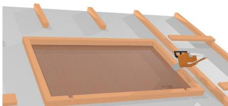
Retirez le film de toiture et l'isolation à l'intérieur du contre-lattage.
