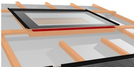
Pour le lattage du module inférieur, fixez une latte en bois de 8 mm d'épaisseur (au moins 60-80 mm de large) au ras du bord inférieur du lattage du module dans la zone du module située sous la fenêtre. Lors du montage des modules, cette latte sert de support pour le module inférieur, qui est poussé sous la fenêtre sans profilé de raccordement au toit.
