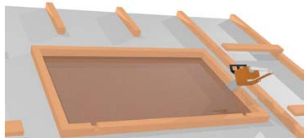
Bauen Sie anschliessend die Arres-Module wieder so weit zurück, dass Sie gut im Bereich des Fensters arbeiten können.
