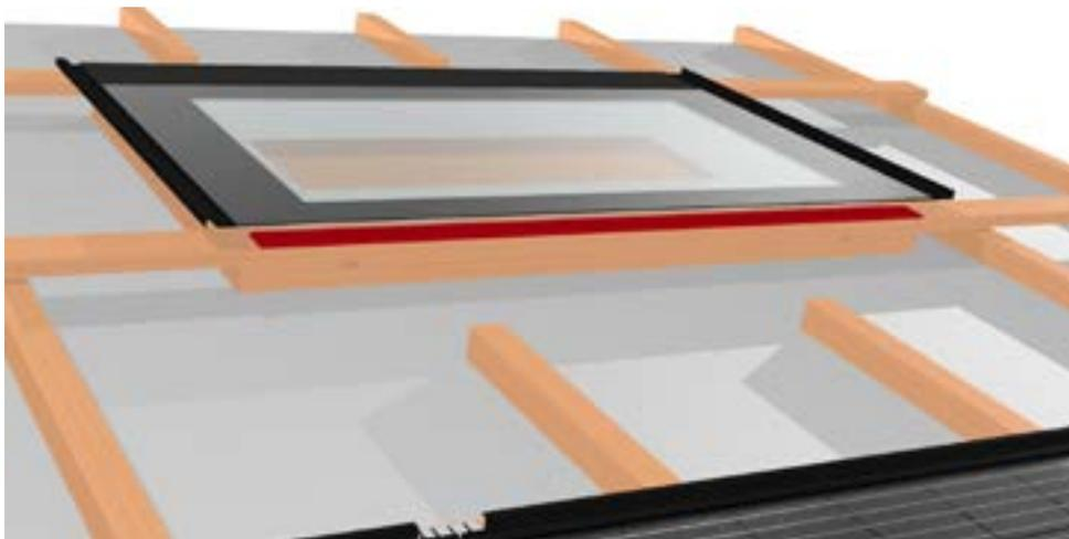
Befestigen Sie bei der unteren Modullattung im Bereich des unterhalb des Fensters liegenden Moduls eine 8mm starke Holzlatte (mindestens 60-80mm breit) bündig mit der Unterkante der Modullattung. Diese Lattung dient bei der Montage der Module aus Auflage für das untere Modul, welches ohne Dachanbindeprofil unter das Fenster geschoben wird.
