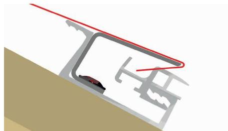
**Pour assurer l'étanchéité au niveau du faîtage, le rebord inférieur doit dépasser dans la gouttière de drainage supérieure et faire pression contre l'arrondi du profilé supérieur. Le rebord idéal a un angle de 28° et une longueur de 22 mm.**
