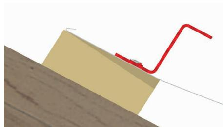
Comme illustré sur l'image de gauche, formez un « Z » avec la tôle perforée supérieure. Le rebord supérieur servira dans une étape de montage ultérieure à recevoir la tôle faîtière et doit donc se terminer à la hauteur du toit.
