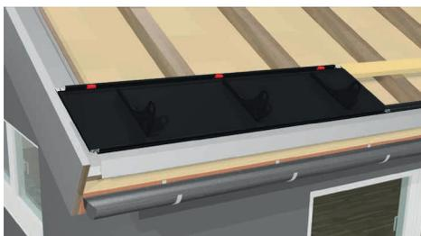
Contrôlez également ici la position correcte du profilé de fixation au toit du cadre, et retirez l'espaceur une fois le montage effectué.
