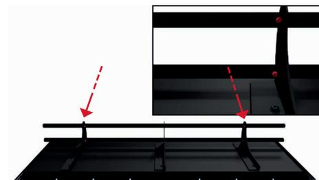
Insérez des vis autoperceuses supplémentaires au niveau des supports pour les tubes de dispositif de retenue de neige qui ont été montés sans raccords dans de courtes zones de l'installation, et ce afin d'éviter que les tuyaux ne bougent dans les deux directions.
