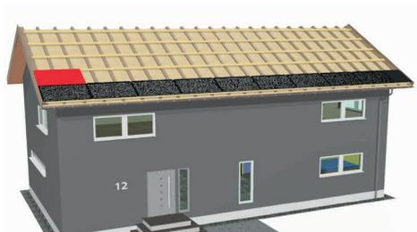
Commencez le montage du second rang là encore du côté gauche. Pour ce faire, faites coulisser le panneau dans l'insertion du profilé de raccordement du toit du panneau situé en dessous.
