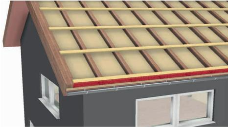
Bouchez l'espace entre le lattage transversal et la surface du toit avec une tôle perforée afin d'écarter tous dégâts sur l'installation ou bien sur le toit qui pourraient être causés par des rongeurs ou par des nids d'oiseaux.
