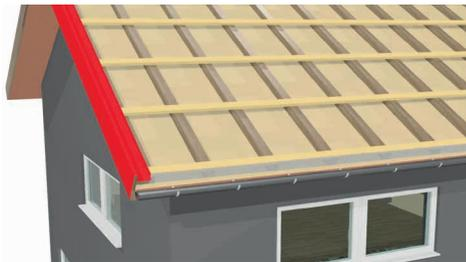
Veillez désormais monter les tôles permettant l'écoulement latéral de l'eau.
