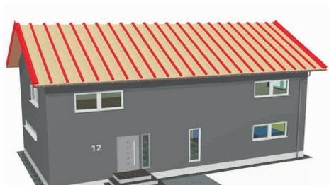
Vissez à présent le contre-lattage à l'abergement. Posez une bande d'étanchéité adhésive sur le contre-lattage pour une étanchéité parfaite de la sous-toiture.
