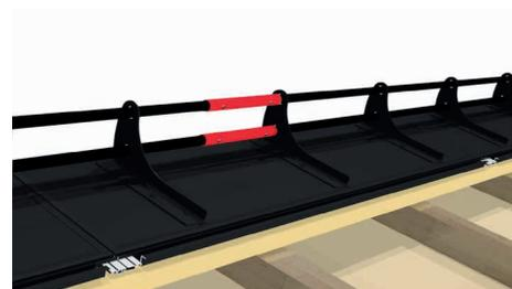
Si vous souhaitez agrandir les tubes, reliez-les avec les raccords de tubes de dispositif de retenue de neige fournis. Veillez à ce que les tubes soient positionnés les uns à côté des autres sans qu'un écart ne se forme. Montez les raccords de façon à ce que les deux extrémités des tubes qui dépassent les raccords aient la même longueur. Cette longueur doit faire au moins 12 cm.
