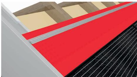
Montez la tôle d'abergement supérieure avec la tôle perforée supérieure. Le lattage transversal supérieur doit être positionné au préalable conformément à la géométrie de la tôle.
