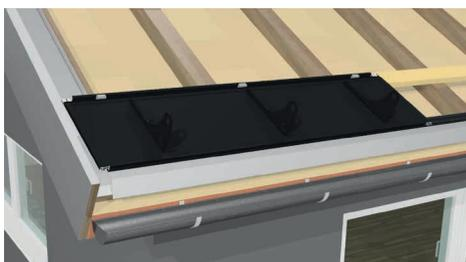
À présent, accrochez le premier panneau de retenue de neige au niveau du bord inférieur à gauche de l'installation dans le rail de base et fixez-le de la même manière que le panneau lui-même, à l'aide des vis de fixation (voir chapitre 6).
