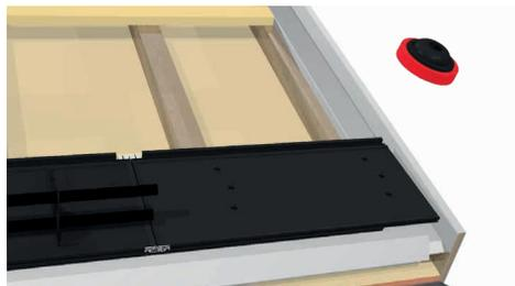
Au niveau de la bordure de l'installation, il peut être nécessaire de raccourcir les panneaux factices à dispositif de retenue de neige. Un dispositif de retenue de neige ne peut être installé sur ces panneaux en raison de leurs propriétés statiques.
