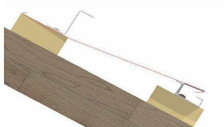
Dimensionnez la tôle d'abergement supérieure suivant les caractéristiques du toit de façon à ce que les rebords puissent recevoir le crochet de faîtage et la tôle perforée.
