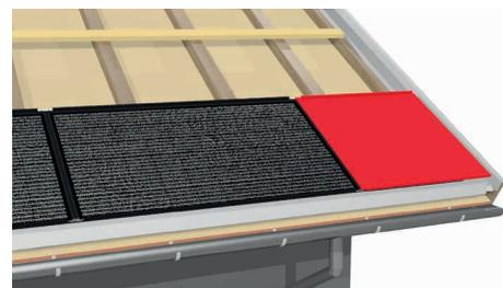
Montez le premier panneau factice pour servir d'abergement de la rangée. Pour ce faire, adaptez comme il se doit les dimensions sur votre toit. Le module factice raccourci doit être fixé au toit avec au moins 2 vis. Si nécessaire, ajoutez un trou supplémentaire ( $\varnothing$  6,5 mm) dans le profil de connexion s'il n'en reste qu'un après le raccourcissement.
