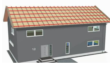
Vissez à présent le lattage du panneau sur le contre-lattage conformément à la planification de l'installation. Le lattage du panneau doit avoir une hauteur minimale de 30 à 40 mm et une largeur minimale 80 à 100 mm.
