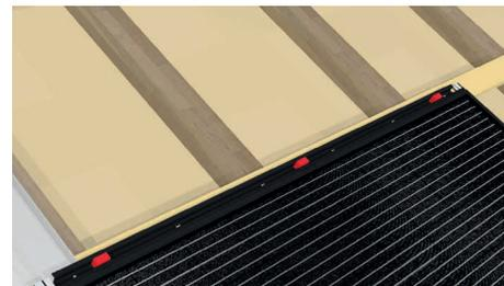
Au cours du montage, contrôlez en permanence le positionnement correct du profilé de fixation au toit perforé du cadre du panneau. Pour ce faire, déplacez le profilé vers le haut dans la partie correspondante du profilé supérieur du cadre.
