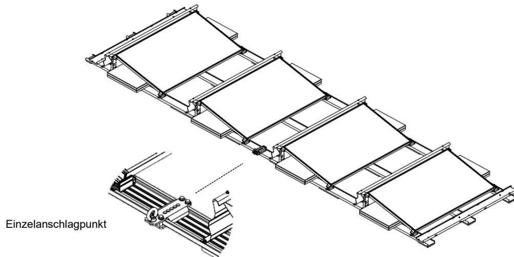
Bild 3: Einzelanschlagpunkt (Nord/Süd Auslegung)
