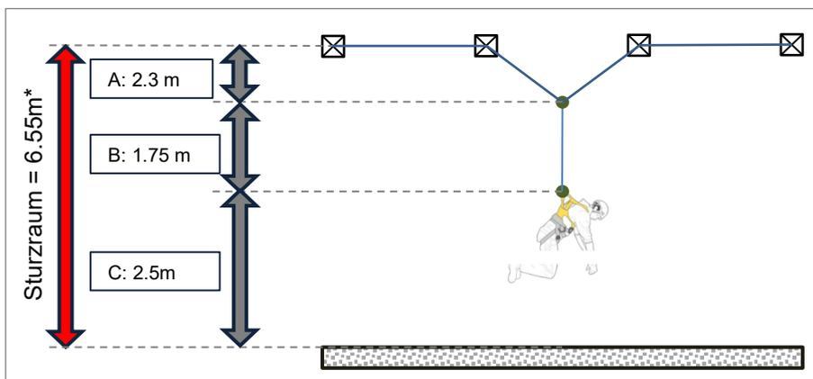
Bild 6: Darstellung zur Berechnung des erforderlichen Sturzraums der Seilanlage
