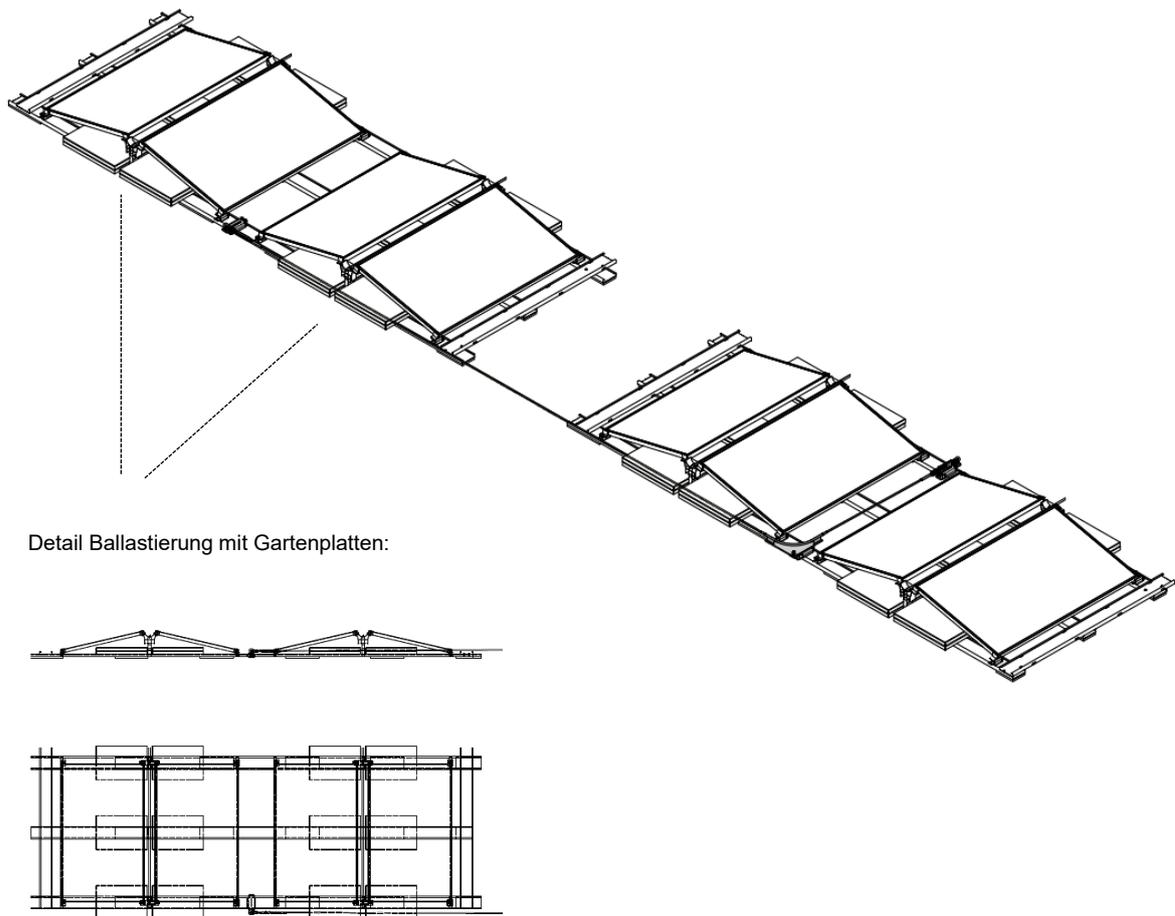
Bild 4: Seilanlange **Sunline**<sup>®</sup>, welche zwei nicht mit Schienen gekoppelte Solarfelder verbindet
