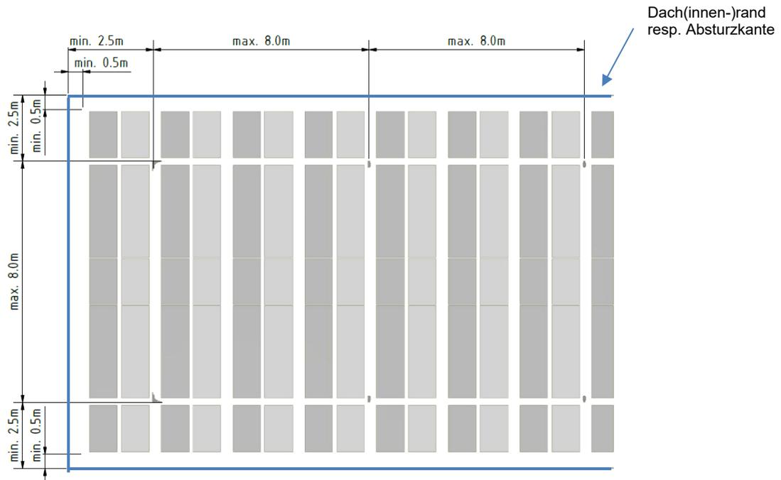
Bild 5: Einzuhaltende Mindestabstände von Seilanlage/Einzelanschlagpunkt zum Dachrand / Absturzkante und maximale Feldlänge
