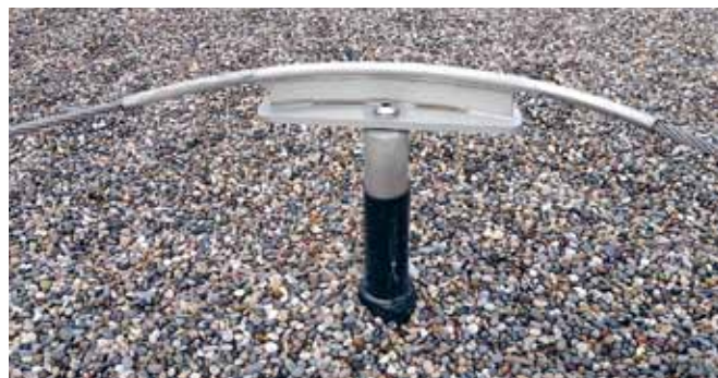
Abb. 6: Frei überfahrbarer Eckpunkt
