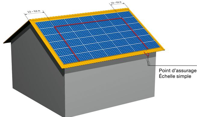
19 Exemple de protection contre les chutes avec système sur rails
