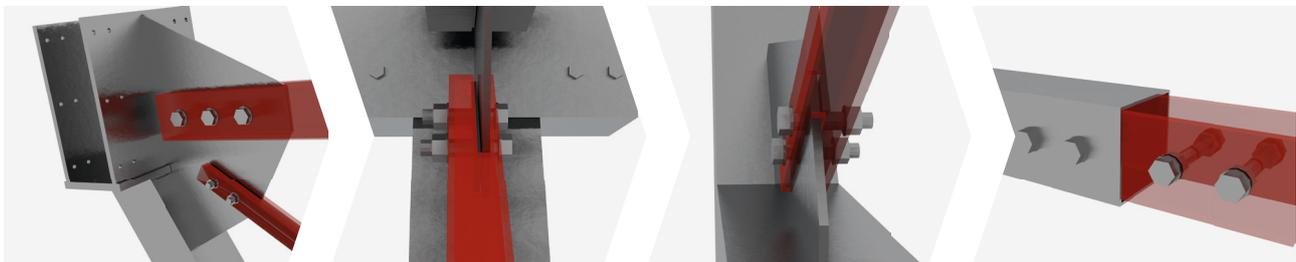
**ZUGSTAB UND DRUCKROHR EINSETZEN UND VERSCHRAUBEN**
