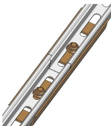
Raccorder les extrémités du rail, centrer le raccord de rail et le relier au rail à l'aide des vis de fixation fournies dans le kit. Le raccord et le nombre de vis dépendent du rail (MV 1.1). Longueur maximale du rail sans séparation 17 m, puis installer un joint de dilatation ou une attache libre (MV 1.3).
