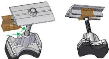
Insérer la pièce de mise à la terre sous la tête et au-dessus du des attaches centrales.
