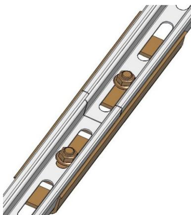
Schienenenden dicht stoßen, Schienenverbinder mittig anlegen und über die im Set enthaltenen Befestigungsschrauben mit der Schiene verbinden. Der Verbinder und die Anzahl Schrauben richten sich nach der Schiene (MV 1.1). Maximale Schienenlänge ohne Unterbrechung 17 m, danach Dehnfuge oder Loslager einbauen (MV 1.3).
