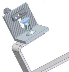
Winkel im Langloch des Dachhakens fixieren, Unebenheiten des Daches durch unterschiedliche Positionierung des Winkels ausgleichen. Bei Horizontalschienenmontage Winkel um  $90^\circ$  gedreht montieren.
