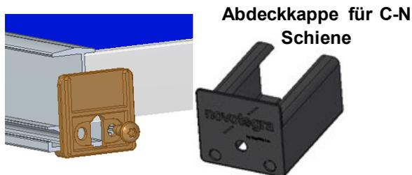
Randanschlag am Ende einer Modulreihe an jeder Einlegeschiene mit einer Blechschraube im Schraubkanal montieren.
