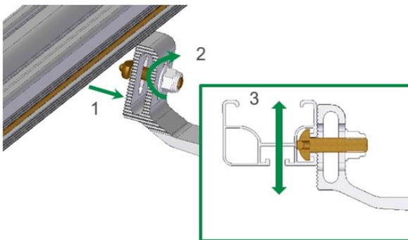
C-N-Schiene im Bereich des Langloches an den Dachhaken anlegen (1), Schraubenkopf um  $90^\circ$  drehen bis Nutenschraube in der Nut verankert ist (2), Schiene ausrichten (3), so dass Unebenheiten des Daches ausgeglichen werden und Riffelungen ineinandergreifen, anschließend anziehen. Der Anschluss des Dachhakens kann auch am Schienenverbinder im Stoßbereich erfolgen.
