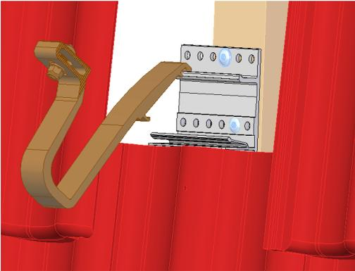
Den Bügel des Dachhakens oben am Grundprofil einhängen und auf dem Grundprofil so ausrichten, dass der Bügel im Wellental des unteren Dachziegels platziert werden kann.
