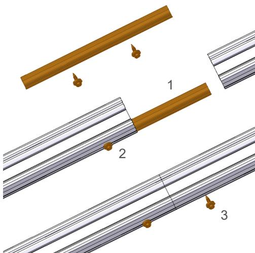
Verbinder (1) zur Hälfte in eine der zu verbindenden Schienen einschieben (2) und dort mit einer Bohrschraube in der seitlichen Bohrrille fixieren. Anschließend die andere Schiene vollständig auf den Verbinder schieben, so dass beide Schienenenden zusammenstoßen (3) und ebenfalls mit einer Bohrschraube fixieren. Maximale Schienenlänge ohne Unterbrechung 13 m, danach Dehnfuge einbauen.
