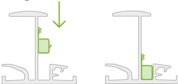
Unter jedem Modul muss ein Kontaktblech montiert werden. Das Kontaktblech muss im Kanal bis auf den Grund der Einlegeschiene gedrückt werden.
