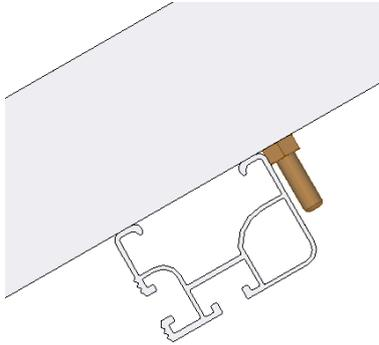
Vor der Modulmontage sind in der unteren Schienenlage die Modulabrutschsicherungen an den Rahmenbohrungen zu montieren. Zur Erleichterung der Modulmontage wird der Einsatz der Abrutschsicherung an allen Modulen empfohlen.
