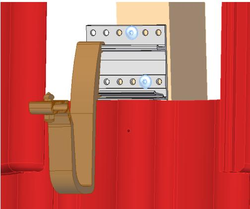
Bügel hinunterdrücken bis einem ein deutliches Klicken signalisiert, dass der Dachhaken korrekt im Grundprofil eingerastet ist. Ein zusätzliches Verschrauben ist an dieser Stelle nicht notwendig.
