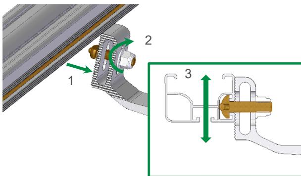
C-N-Schiene im Bereich des Langloches an den Dachhaken anlegen (1), Schraubenkopf um 90° drehen bis Nutenschraube in der Nut verankert ist (2), Schiene ausrichten (3), so dass Unebenheiten des Daches ausgeglichen werden und Riffelungen ineinandergreifen, anschließend anziehen. Der Anschluss des Dachhakens kann auch am Schienenverbinder im Stoßbereich erfolgen.
