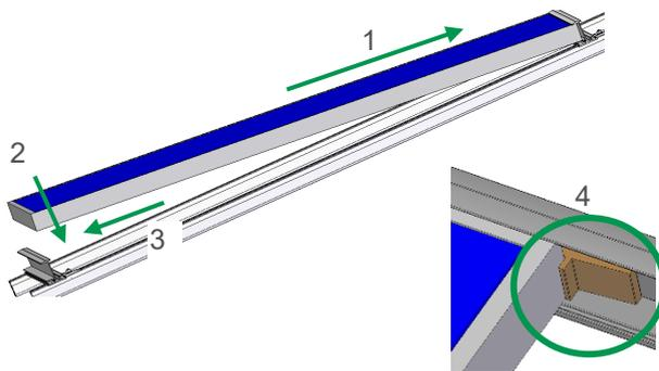
Modul auf die obere Einlegeschiene aufsetzen und nach oben schieben (1). Danach das Modul auf die untere Einlegeschiene absetzen (2) und nach unten gegen die Einlegeschiene ziehen (3). Folgemodule nach demselben Prinzip montieren, der Spalt zwischen den Modulen muss mind. 3 mm betragen.
