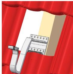
Dachhaken einlegen, sodass der Bügel im Wellental des Dachziegels liegt. Deckziegel und ggf. unteren Ziegel an der Austrittsstelle der Dachhaken markieren. Falls Abstand zum Ziegel nicht eingehalten werden kann, entweder zusätzliche Unterlegplatten (Optionalartikel) oder Dachhaken ZD 30 N35 bzw. Dachhaken ZD 633 verwenden. Für Biberschwanzeindeckungen ist nach MV 2 (Montagevariante – Klemmsystem) vorzugehen.
