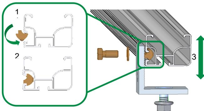
Nutensteine in die Nut der C-N-Schiene positionieren (1+2). Schiene ausrichten, so dass Unebenheiten des Daches ausgeglichen werden (3) und Riffelungen ineinandergreifen, anschließend festziehen.
