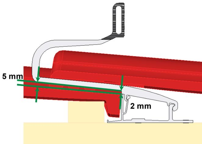
Die Mindestabstände zwischen unterem Ziegel und Tragbügel müssen eingehalten werden. Falls Abstand zum Ziegel nicht eingehalten werden kann müssen zusätzliche Unterlegplatten (Optionalartikel) verwendet werden. Für Biberschwanzeindeckungen ist nach MV 2 (Montagevariante – Klemmsystem) vorzugehen.
