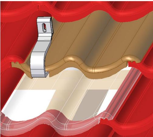
Deckziegel und ggf. unteren Ziegel an der Austrittsstelle der Dachhaken markieren. Falzziegel / Betondachstein im Austrittsbereich der Dachhaken mit Winkelschleifer vorsichtig aussparen.
