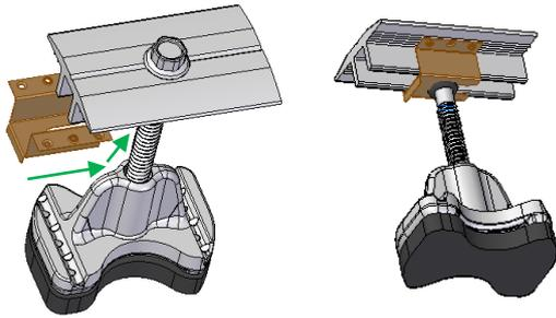
Kontaktblech an der Schiebelasche über die senkrechten Stege der Mittelklemmen bis zur Schraube aufschieben.
