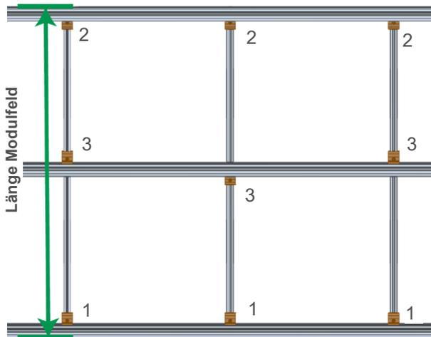
Bei der obersten und untersten Einlegeschiene des Modulfeldes wird das Kreuzschienenverbinder-Set N ES jeweils auf der Innenseite montiert (1,2), in den mittleren Einlegeschiene sind Kreuzschienenverbinder abwechselnd oben und unten am Halteflansch anzubringen (3).
