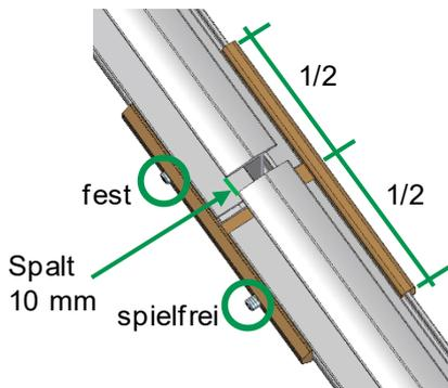
Schienenverbinder über montierte Schiene mittig schieben und ersten Gewindestift fest anziehen. Anschließende Schiene in den Verbinder einschleiben - Spalt zwischen den Schienen 10 mm - zweiten Gewindestift spielfrei anziehen. Für die Montage der Einlegeschiene Plus ist MV 1 zu beachten.
