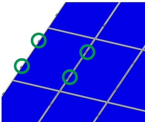
Danach sind die Module mit End- und Mittelklemmen an den Schienen zu befestigen.
