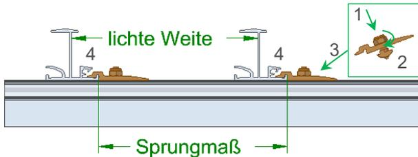
Kreuzschienenverbinder-Set N ES von oben in die Schienennut einführen (1). Mutter um 90° verdrehen (2) und Bauteil gegen die Einlegeschiene schieben (3), so dass der Kreuzschienenverbinder sich mit dem Halteflansch verriegelt (4).
