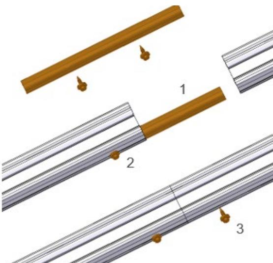
Verbinder (1) zur Hälfte in eine der zu verbindenden Schienen einschieben (2) und dort mit einer Bohrschraube (ca. 20mm Randabstand) in der seitlichen Bohrrille fixieren. Anschließend die andere Schiene vollständig auf den Verbinder schieben, so dass beide Schienenenden zusammenstoßen (3) und ebenfalls mit einer Bohrschraube fixieren (ca. 20mm Randabstand). Maximale Schienenlänge ohne Unterbrechung 13 m, danach Dehnfuge einbauen.
