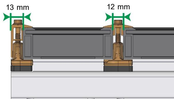
Endklemmenmontage bündig mit dem Schienenende möglich.
