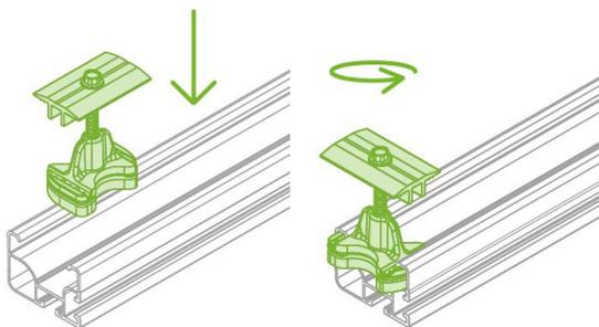
Mittel-bzw. Endklemmen an der Klemmstelle von oben in die Schienenkammer einführen. Anschließend die Schienenmutter in der Schiene drehen und Modulklemmen an den Modulrahmen anschieben.
