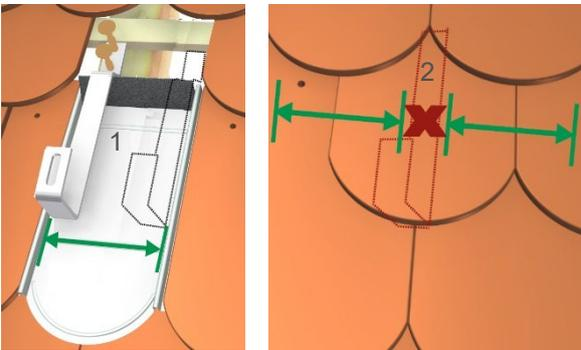
Dachhaken mittig auf den Sparren ausrichten (1). Zulässige Abstände der Schrauben zum Sparrenrand einhalten. Verschraubungen und Auflagepunkt nicht an den Stellen einer Fuge platzieren (2). Holzschrauben ohne Vorbohren eindrehen.
