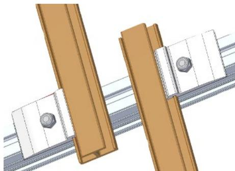
Stützschiene ES mit dem Kreuzschienenverbinder-Set C ES befestigen - die Stützschiene sind parallel zu den Einlegeschiene zu montieren und im Überlappungsbereich auf der C-N-Schiene versetzt anzuordnen.
