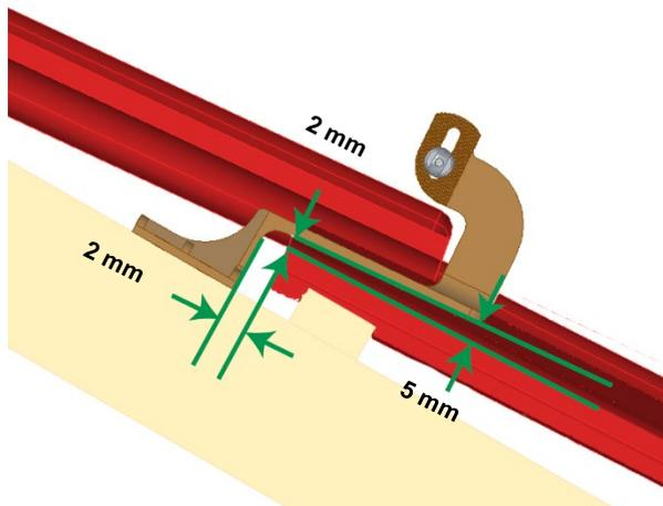
Die Mindestabstände zwischen unterem Ziegel und Tragbügel müssen eingehalten werden. Passen Sie den Dachhaken mittig auf den Sparren ein.
