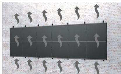
Sehr gute Hinterlüftung der Module
