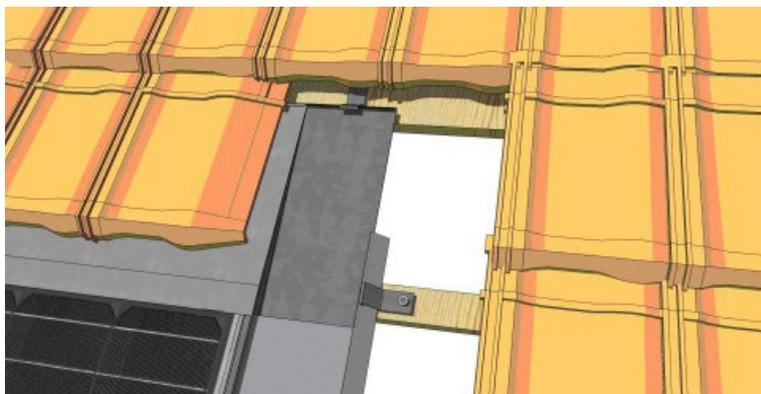
Enfin, faites glisser la tôle d'angle droite dans la tôle faîtière et dans la tôle d'abergement droite, ou dans la rangée supérieure, puis fixez-la à l'aide des crochets de fixation au lattage en bois.
