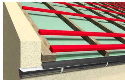
Veillez à ce qu'il y ait suffisamment de place pour les tôles permettant l'écoulement latéral de l'eau.
