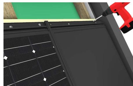
En raison de la coupe des panneaux factices, mais aussi par exemple lorsqu'un panneau avance dans la conduite de l'eau latérale, le profilé de fixation au toit ne peut pas être vissé au toit avec les deux trous ronds.
