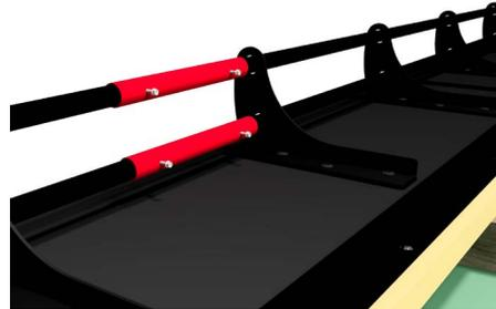
Si vous souhaitez agrandir les tubes, reliez-les avec les raccords de tubes de dispositif de retenue de neige fournis. Veillez à ce que les tubes soit positionnés les uns à côté des autres sans qu'un écart ne se forme. Montez les raccords de façon à ce que les deux extrémités des tubes qui dépassent les raccords aient la même longueur. Cette longueur doit faire au moins 12 cm.
