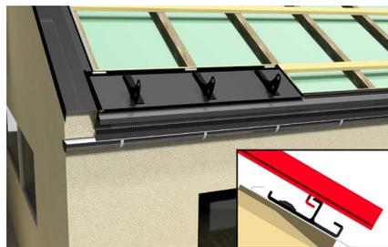
Veillez désormais monter le premier panneau factice à dispositif de retenue de neige sur la bordure en bas à gauche de l'installation. Procédez de la même façon que pour le montage des panneaux (voir chapitre 6).
