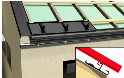
Montieren Sie nun das erste Schneefangblindmodul am unteren, linken Anlagenrand. Gehen Sie dabei gleich vor, wie bei der Montage der Module (siehe Kapitel 6).
