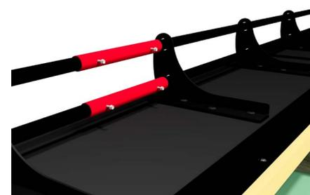
Um Schneefangrohre zu verlängern verbinden Sie diese mit den mitgelieferten Schneefangrohr-Verbindern. Achten Sie darauf, dass die Schneefangrohre ohne Spalt zueinander positioniert sind. Montieren Sie die Verbinder so, dass beide Rohrenden wo möglich gleichweit in den Verbinder ragen. Mindestens aber 12cm.
