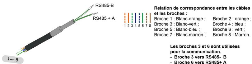
**Étape 3** Branchez le câble de communication sur les ports RS485 du Logger1000, comme représenté dans la figure ci-dessous.
