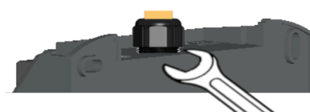
Abb. 6-15: Kabelverschraubung von der Rückseite festziehen
